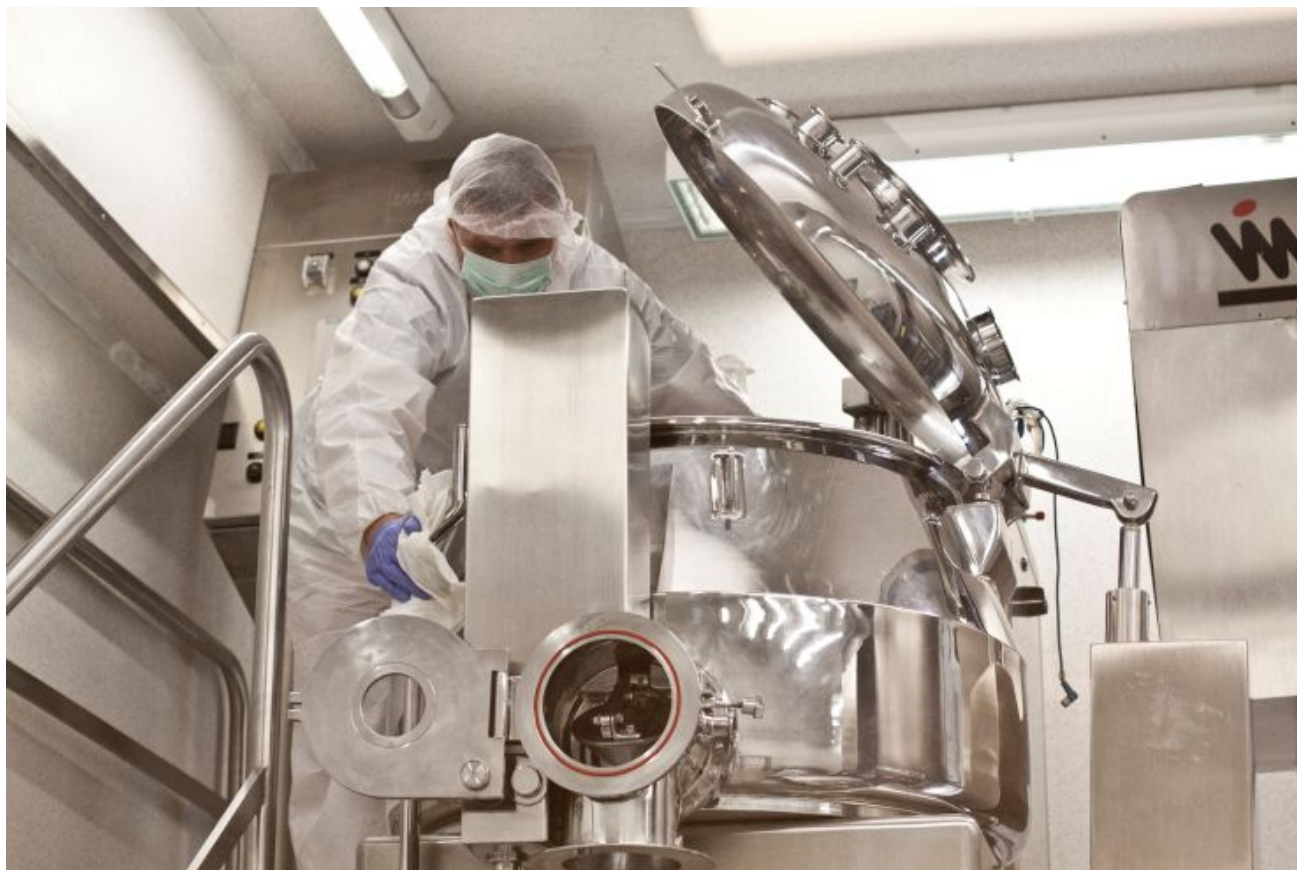
czyszczenie granulownicy_mierzarki fot. Lekam
