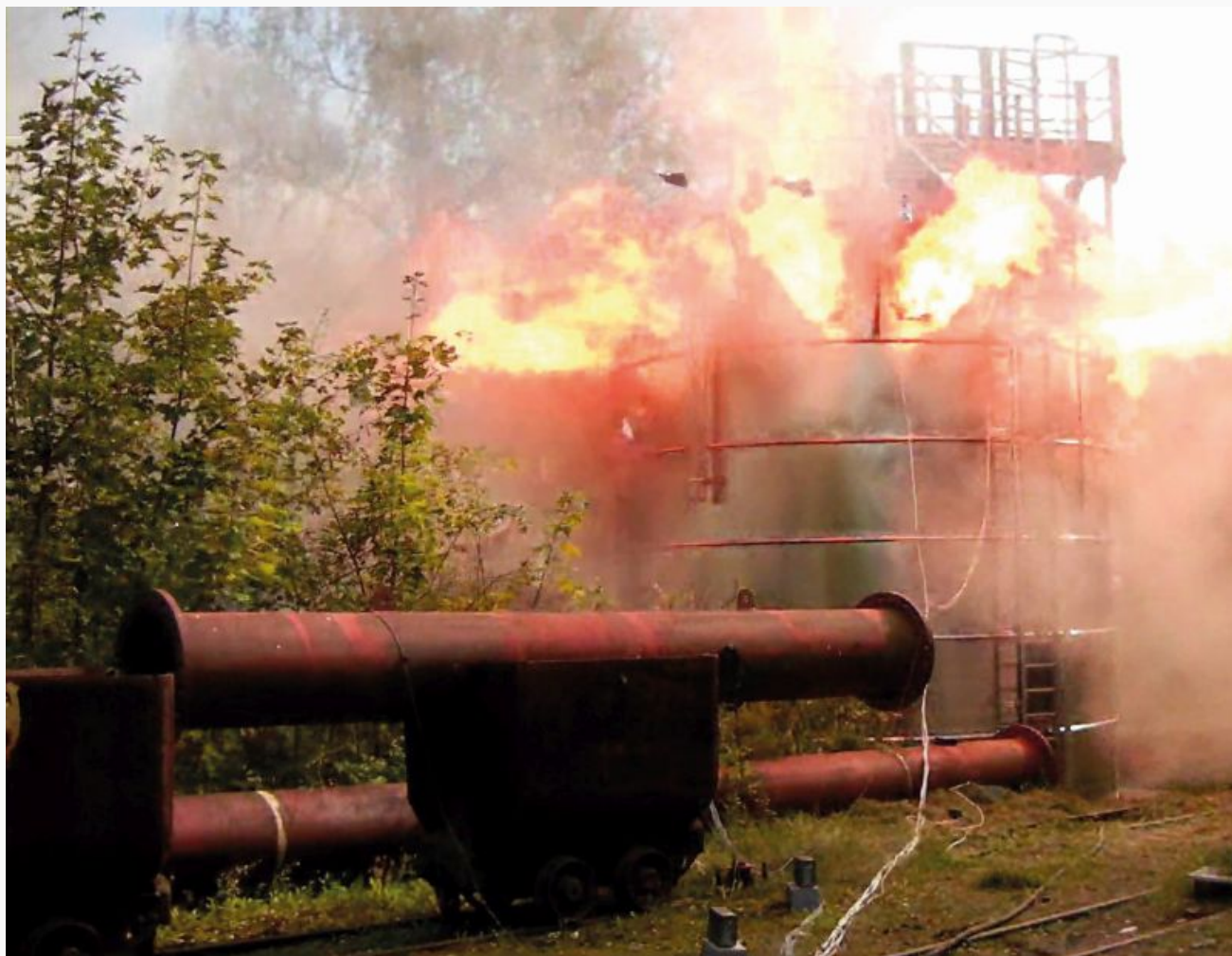
silos_wybuch-pyłu-zbożowego-w-silosie-zbożowym-w-Kopalni-Doświadczalnej-Barbara fot. mat. prasowe
